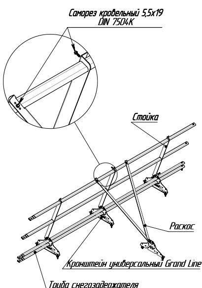
⑤ Установите трубу снегозадержателя во второе снизу по счёту отверстие в стойке ограждения, продев трубу через отверстия в стойках и раскосах. Средняя стойка ограждения должна оказаться между раскосами. Закрепите кровельными саморезами 5,5x19 трубу снегозадержателя в стойках. Раскосы к трубе на данном этапе не прикрепляются.
