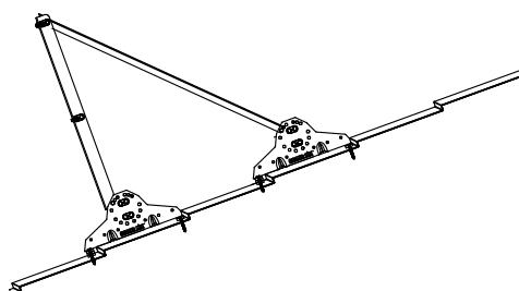
⑦ Вставьте оставшиеся трубы снегозадержателя Grand Line® в отверстия стоек и прикрепите стойки к трубам саморезами 5,5x19.
