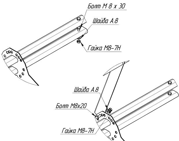
③ Прикрепите к кронштейнам универсальным Grand Line® стойки Премиум с помощью болтов M8x20, гаек и шайб.
