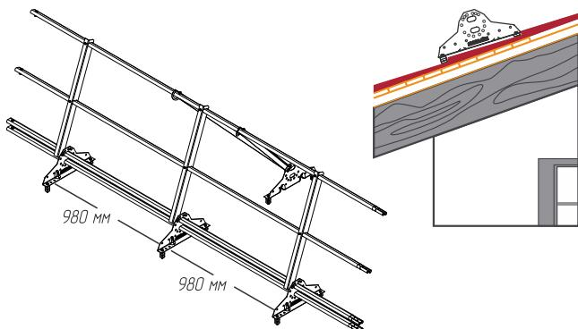
① Установите на кровле кронштейны универсальные Grand Line® на расстоянии 980 мм друг от друга. Кронштейн крепится саморезами 8x60 к обрешётке строго в низ волны металличерепицы. Чтобы исключить соприкосновение кронштейна и полотна металличерепицы накрутите EPDM резиновые уплотнители на саморезы 8x60. Отверстия в обрешётке для саморезов 8x60 необходимо делать не ближе 20 мм от края обрешётки. Кронштейны для раскосов не устанавливать.
